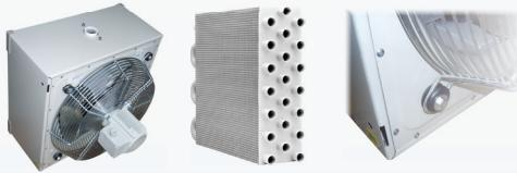
**Теплообменник.** Состоит из стальных труб диаметром 22 мм и алюминиевых ламелей. Такая конструкция обеспечивает очень низкое гидравлическое сопротивление, долговечность, отсутствие би-металлических соединений. Аппараты могут работать как на воде так и на пару.
