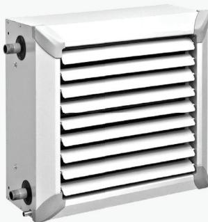
**Теплообменник.** Изготовлен из медных высококачественных трубок и алюминиевых ламелей. Патрубки подключения воды выведены на сторону.
